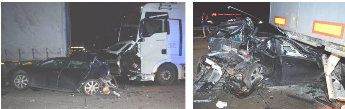
Bild A2: Auffahrunfall eines sehr neuen Sattelkraftfahrzeugs mit vom Fahrer zuvor abgeschaltetem modernem Notbremsystem (EBA2) auf einen Pkw
