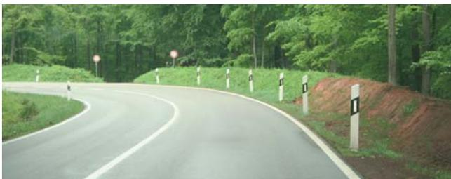
Bild 43: Erdwall statt Schutzplanke
