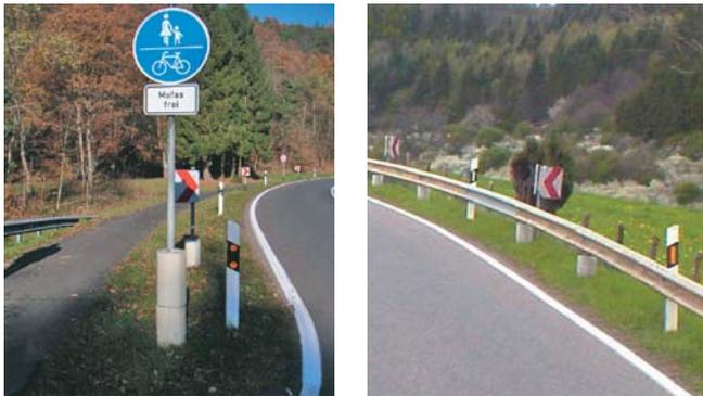
**Bild 70: Ummantelung von Schilderpfosten und Schutzplankenpfosten nur bei geringen Geschwindigkeiten wirksam**
