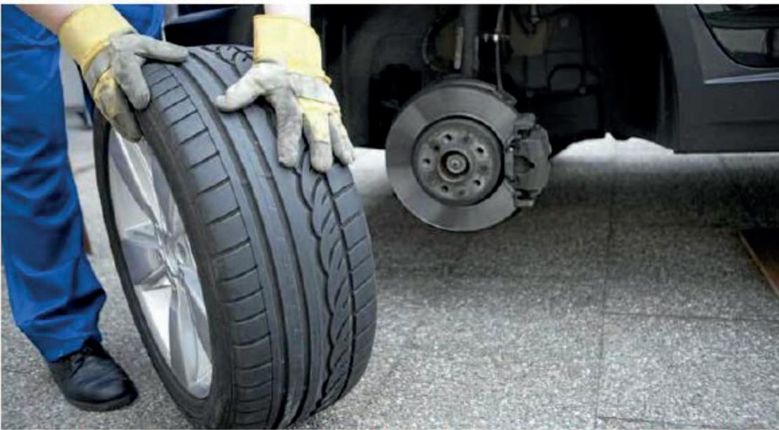
Der Winterreifen soll seine beste Haftung bei Temperaturen unter 0 Grad haben, der Sommerreifen bei über 15 Grad. Experten gehen davon aus, dass bei einer Temperatur der Fahrbahn von 7 Grad beide Reifentypen eine ähnliche Haftung haben. Foto: AdobeStock
