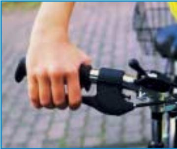
Würden Sie in ein Auto ohne Bremsen steigen? Auch beim Fahrrad sind zuverlässige Bremsen das A und O, um sicher anzukommen. Die Bremshebel müssen vom Kind bequem erreicht und bedient werden können. Auch bei starkem Bremsen dürfen sie den Lenkergriff nicht berühren!
