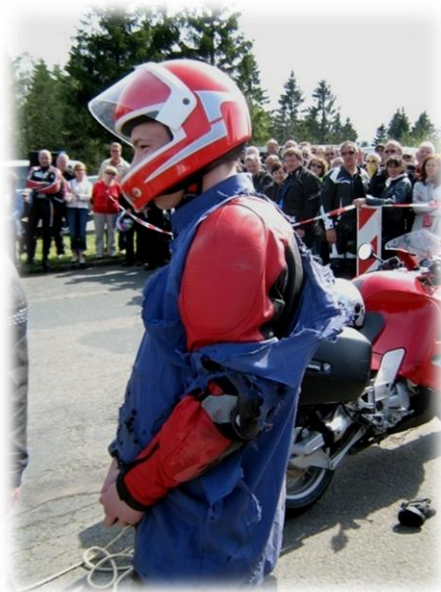
Der Schleiftest zeigt eindrucksvoll die Verletzungsgefahr ohne die richtige Schutzkleidung
